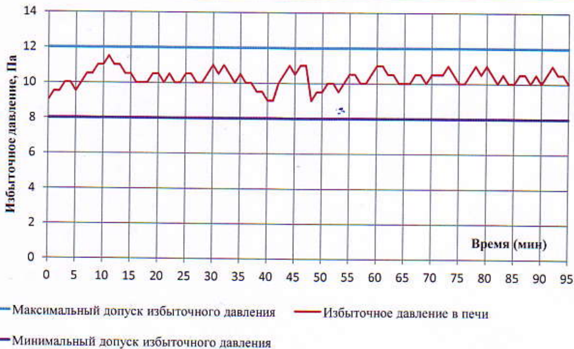
Рисунок 3. График избыточного давления в печи при испытании образца №1
